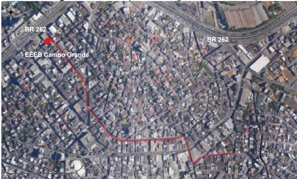
Figura 42 – EEEB Campo Grande e segmento de rede de recalque.
