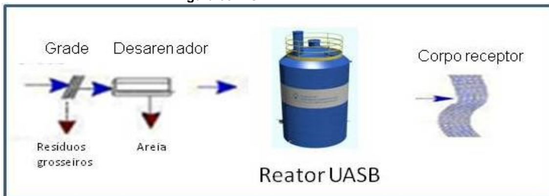
Figura 68 – Unidades da ETE Mocambo.
