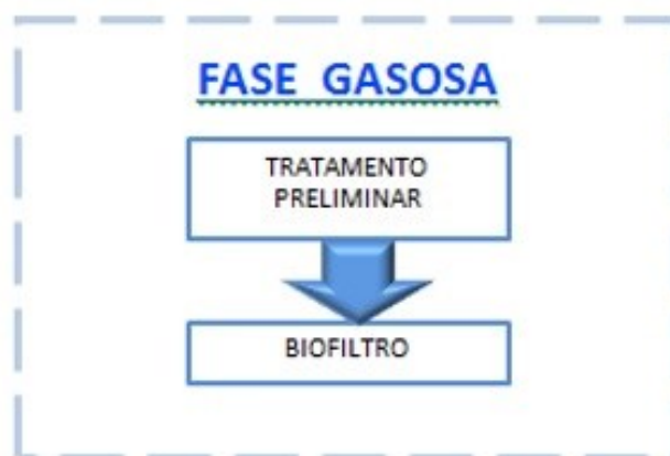
Figura 40 – Fluxograma de tratamento de esgoto - Fase gasosa.
