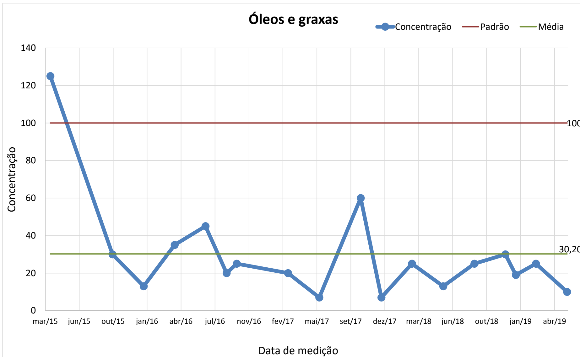
Gráfico 23 - Concentração de Óleos e Graxas (OG) do efluente tratado da ETE Mocambo.
